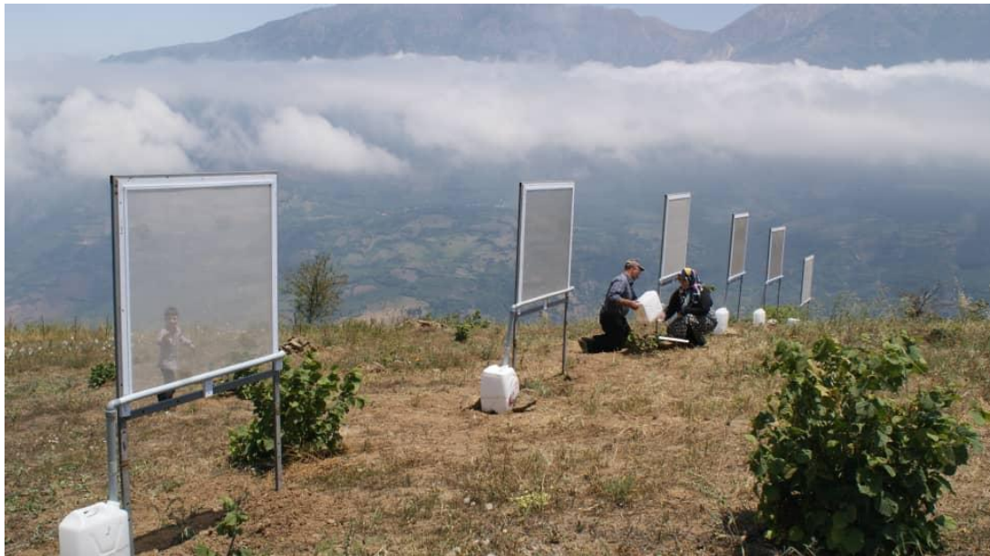
شکل ۵- نمایی از اندازه‌گیری آب جمع‌آوری شده در مخازن Figure 5- A view of measuring water collected in tanks
