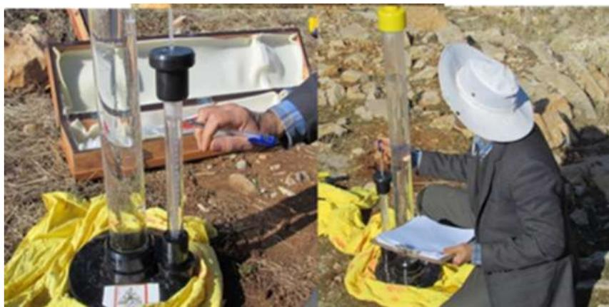
شکل (۳): اندازه‌گیری نفوذپذیری خاک به کمک دستگاه نفوذسنج صفحه‌ای
