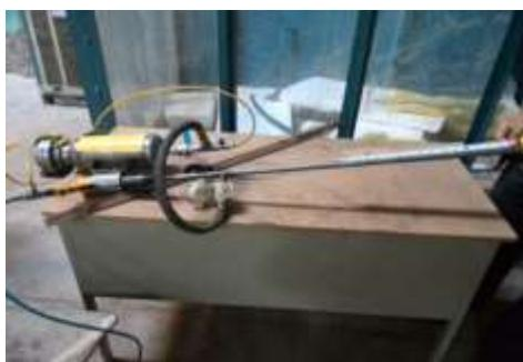
شکل (۳): دستگاه تزریق ابر جاذب (مخزن ۲ لیتری)
