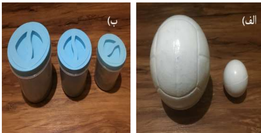
شکل (۳): (الف) شناورهای کروی. (ب) شناورهای استوانه‌ای
