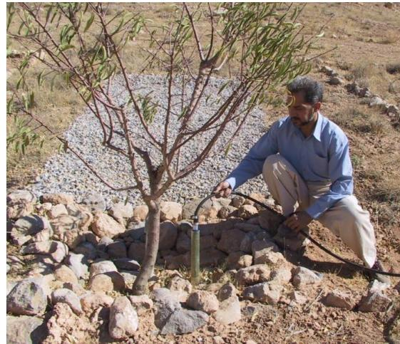
شکل ۹- اندازه‌گیری درصد رطوبت حجمی خاک با استفاده از دستگاه TDR
