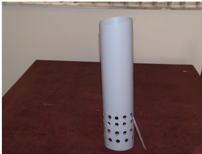
شکل ۳- نمونه‌ای از لوله پلی‌اتیلن که برای ساخت فیلتر سنگریزه‌ای به کار برده شده است Figure 3- An example of a polyethylene pipe used to make a gravelly filter
