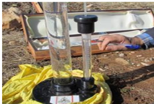
شکل ۲- روش اندازه‌گیری نفوذپذیری خاک به کمک دستگاه نفوذسنج صفحه‌ای
