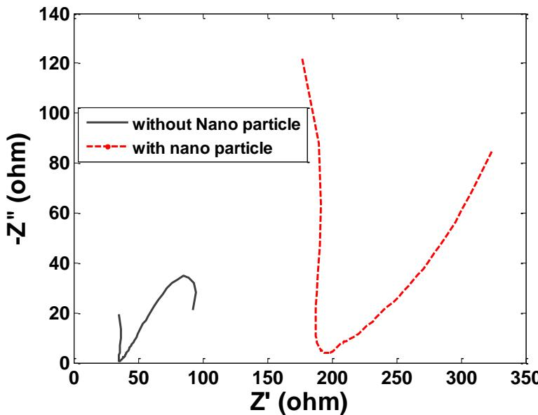
شکل ۴- نتایج EIS با و بدون نانو ذره  $\text{Y}_2\text{O}_3$ Figure 4– EIS results with and without  $\text{Y}_2\text{O}_3$  nanoparticles
