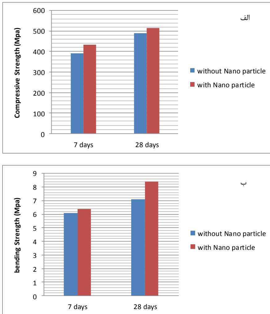
شکل ۳- الف: مقاومت فشاری و ب: مقاومت خمی با حضور و بدون حضور نانو ذره  $\text{Y}_2\text{O}_3$ Figure 3- a- compressive strength, b- bending strength with and without  $\text{Y}_2\text{O}_3$  nanoparticles
