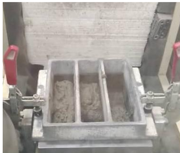
شکل ۲- قرار گرفتن ملات در داخل قالب استاندارد در دو مرحله
