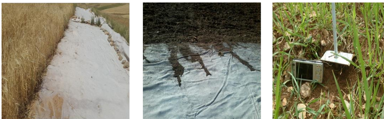
شکل (۶): اندازه گیری مقدار فرسایش خاک از پین‌های فرسایشی و ژئوتکستایل
