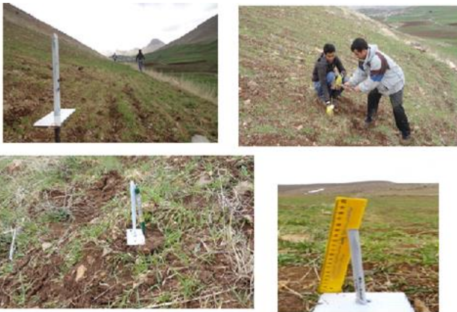
شکل (۴): نصب پین‌های فرسایشی در سطح مزرعه شاهد و تیمار
