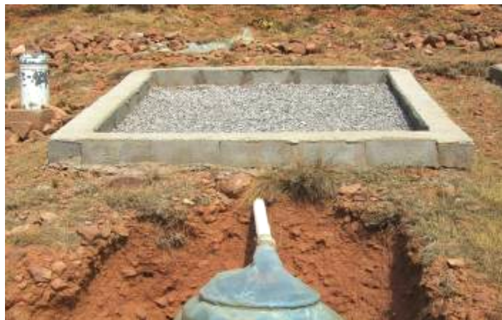
شکل (۴): تیمار سطح طبیعی با پوشش شنی به همراه باران‌سنج
