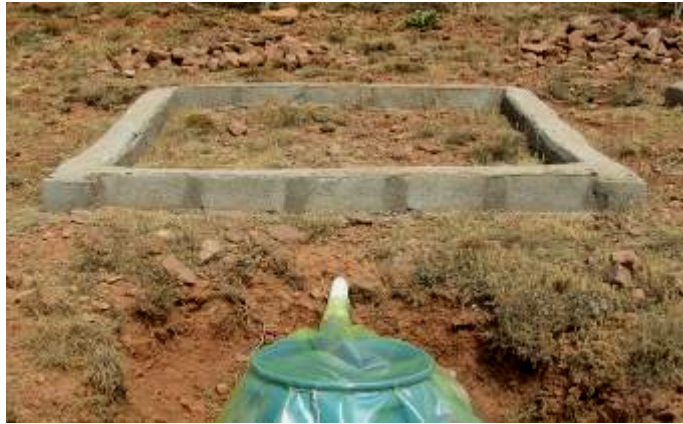
شکل (۳): تیمار سطح طبیعی به همراه مخزن ذخیره رواناب
