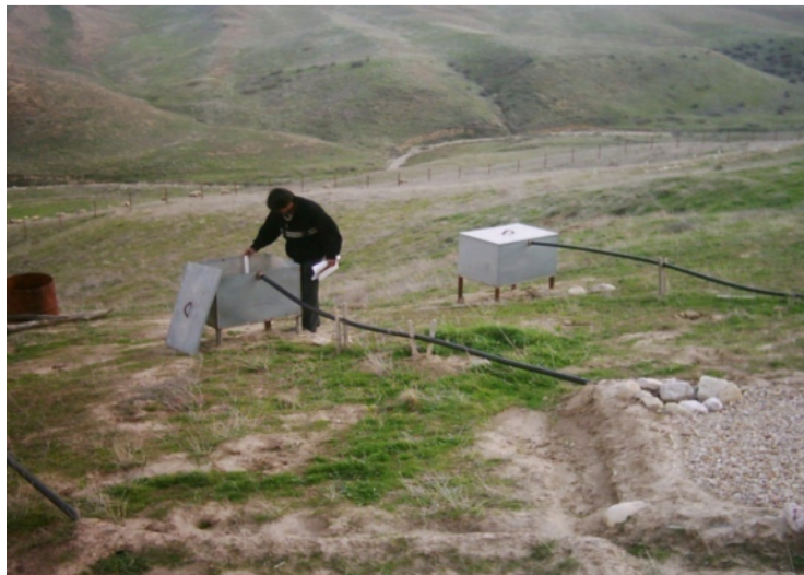
شکل (۴): نمایش اندازه‌گیری مخازن جمع‌آوری رواناب
