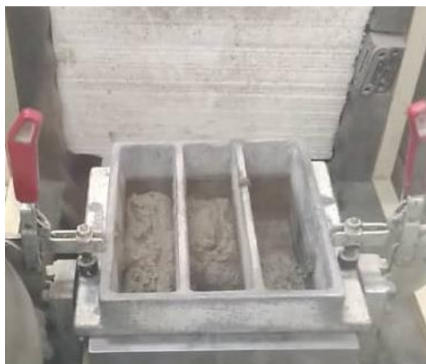
شکل ۲- قرار گرفتن ملات در داخل قالب استاندارد در دو مرحله Figure 2- Placing the mortar inside the standard mold in two steps
