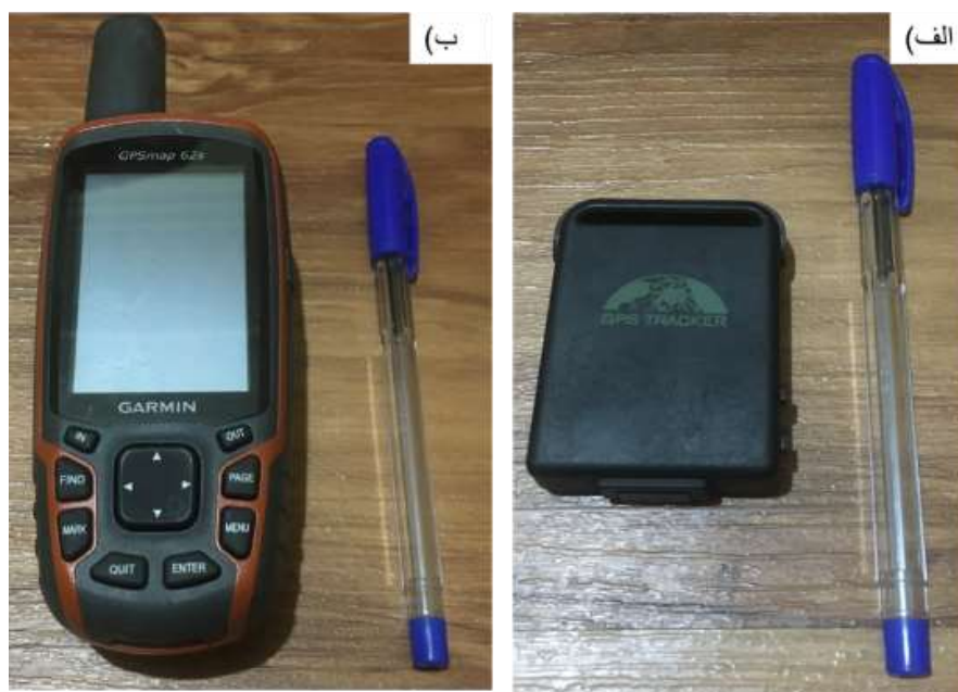
شکل (۴): دستگاه‌های Gps مورد استفاده. (الف) تریکر مدل GT102 (ب) گارمین مدل S62
