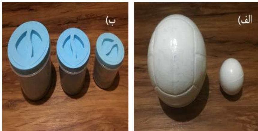
شکل (۳): (الف) شناورهای کروی. ب) شناورهای استوانه‌ای
