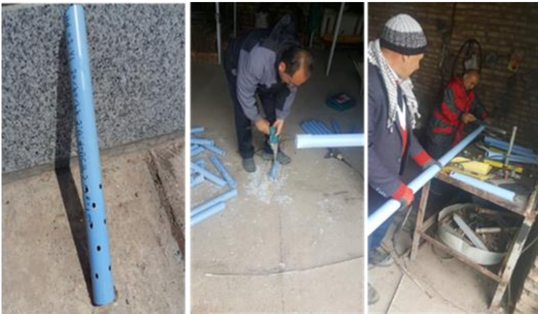
شکل (۴): نحوه تهیه فیلتر سنگریزه‌ای از جنس لوله پلیکا
